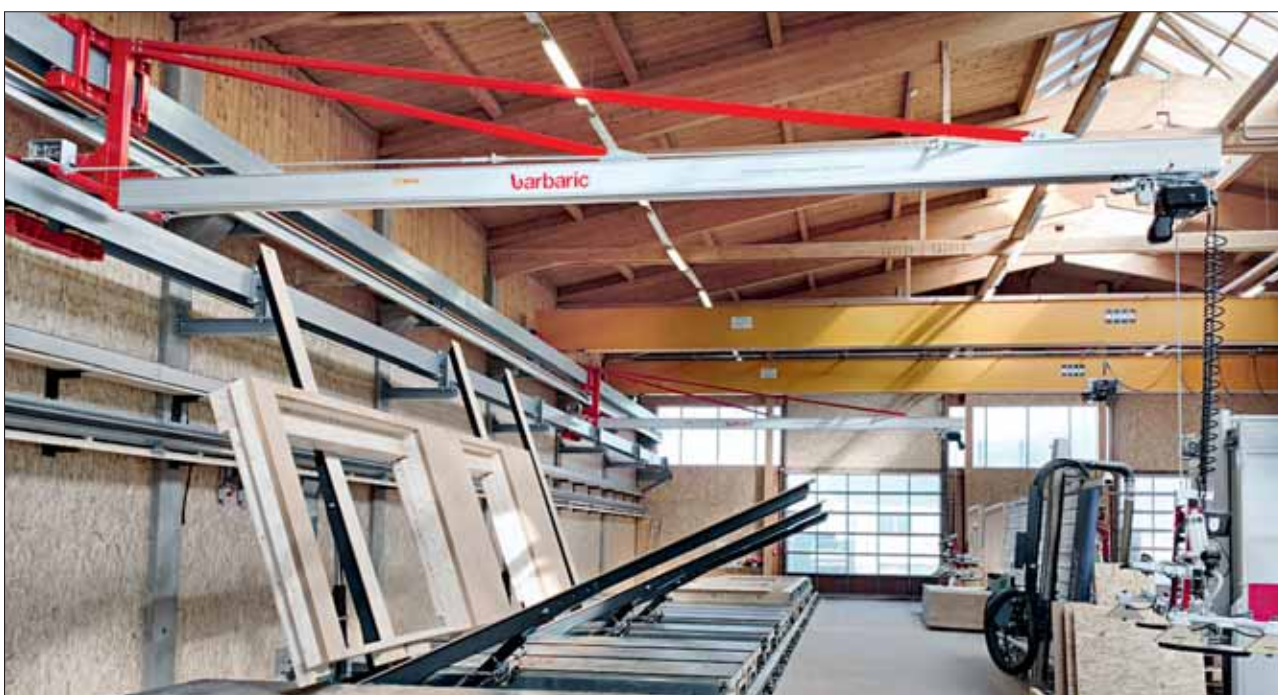
Barbaric hat bei Tiroler Holzhaus das neue „WPC Wand-Portalkransystem“ installiert (darüber ist der Hallenkran zu sehen). Die Kranbahnlänge beträgt rund 45 m, die beiden Ausleger verfügen über eine Länge von rund 9 m. Fotos: Barbaric
