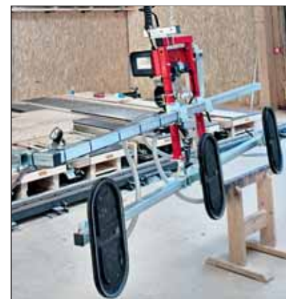
Barbaric hat bei Tiroler Holzhaus das neue „WPC Wand-Portalkransystem“ installiert (darüber ist der Hallenkran zu sehen). Die Kranbahnlänge beträgt rund 45 m, die beiden Ausleger verfügen über eine Länge von rund 9 m. Fotos: Barbaric
