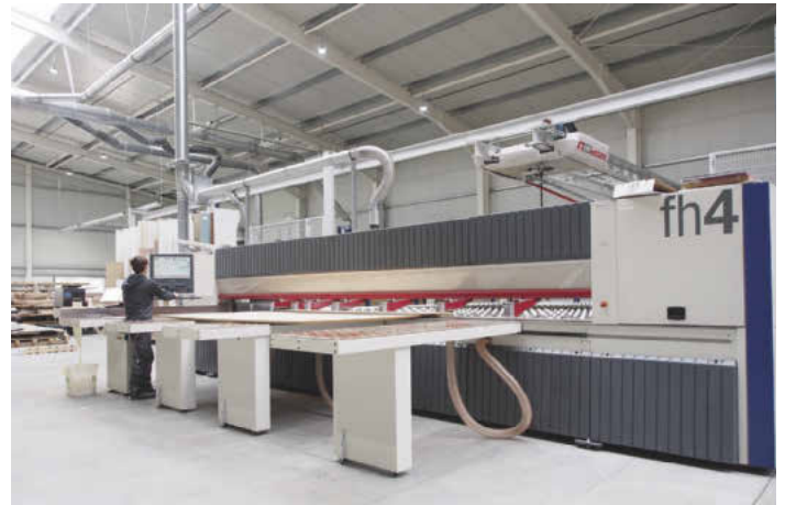
/ Die Druckbalkensäge vom Typ Schelling fh4 steht für hohe Performance und flexible Plattenzuschnitt-Prozesse.
