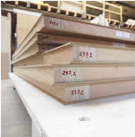
/ Sämtliche Türrohlinge werden selber hergestellt. In der Regel kommt dabei Tischlerplatte zum Einsatz.
