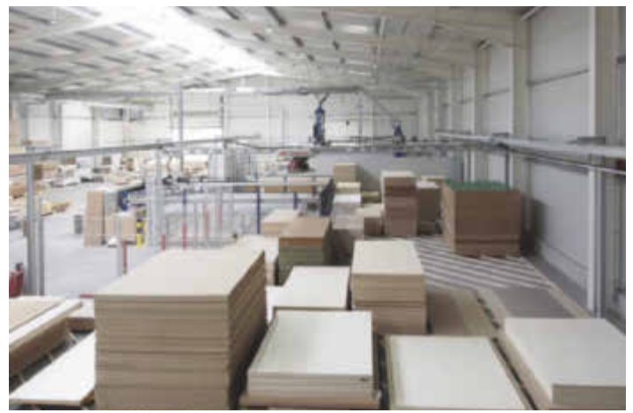
/ Aus dem 35 m langen Barbaric-Plattenlager heraus werden die Schelling-Plattenaufteilsäge (Mitte links) und die Maka-CNC (hinten) vollautomatisch beschickt.
