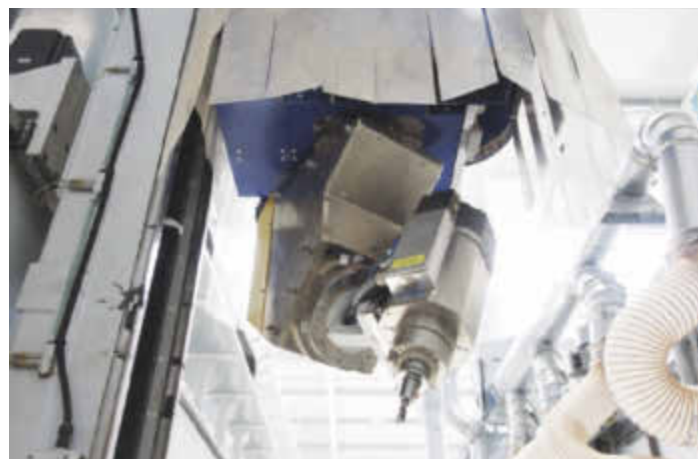
/ Null Spiel: Herzstück der Maka ist die 5-Achs-Spindel mit Galaxie-Antriebssystem von Wittenstein. „Die Spindel ist der Hammer“, schwärmen Josef und Jonas Nießing.
