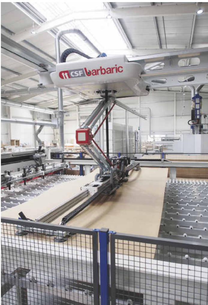
/ Der Manipulator kann dank mehrerer Dutzend spezieller Programme bis hin zum Vollformat alle Plattenarten sicher handhaben, die bei Nießing verarbeitet werden.
