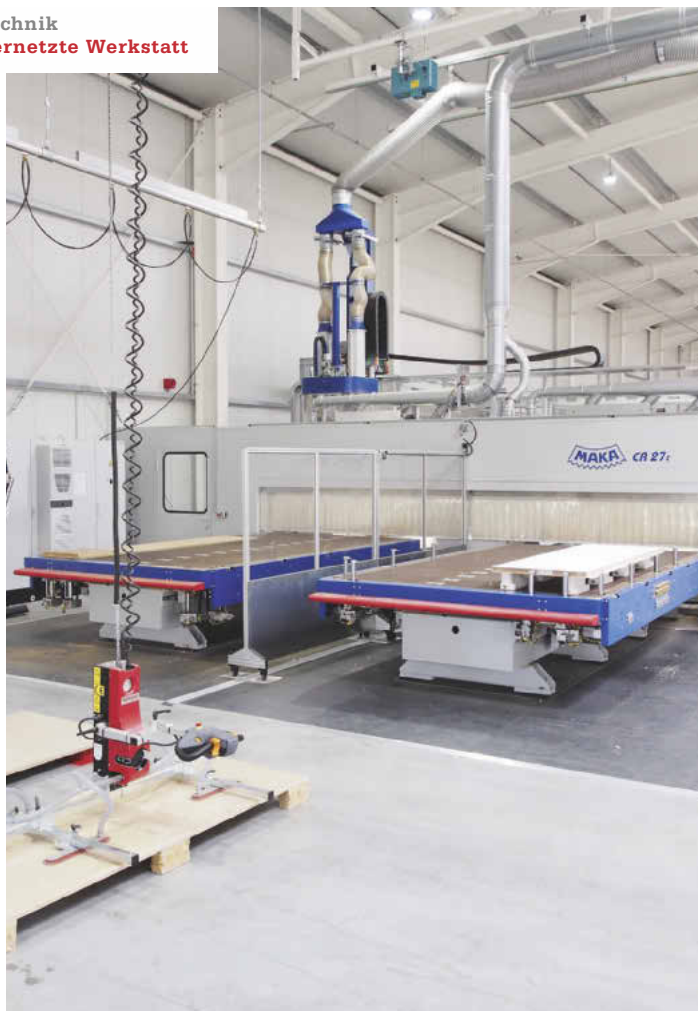
/ Die 5-Achs-CNC CR27 t mit zwei Fahrtischen in Tandemausführung. Besonderheit: Sie kann manuell von vorne sowie vollautomatisch von hinten beschickt werden.
