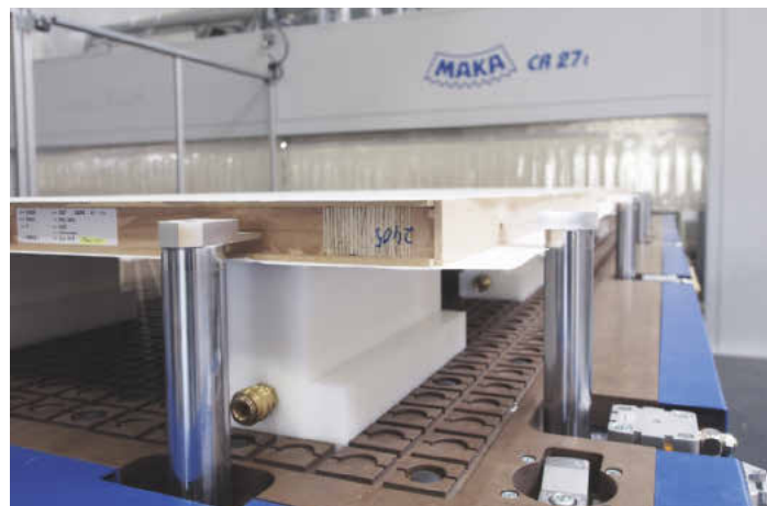
/ Robuste und extrem durchdachte Spanntechnik ermöglicht in Kombination mit einem intelligenten Tisch- und Vakuumkonzept hochpräzises und sicheres Spannen.
