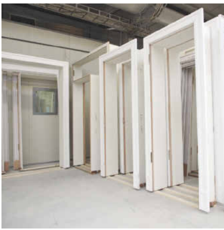
/ Nießing-Standard: Alle Zargen werden in der Werkstatt zusammengebaut und fertig oberflächenbehandelt.
