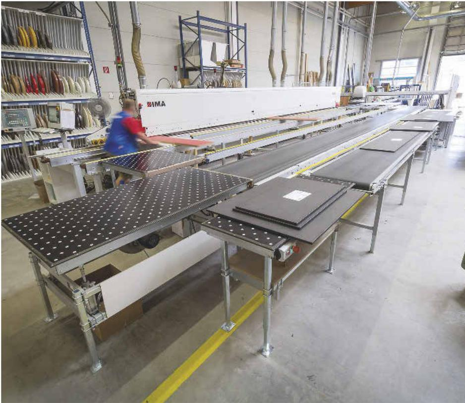
/ Bei der Fertigung von größeren Stückzahlen spart eine Rückführung an der Kantenanleimmaschine Zeit und damit Geld.
