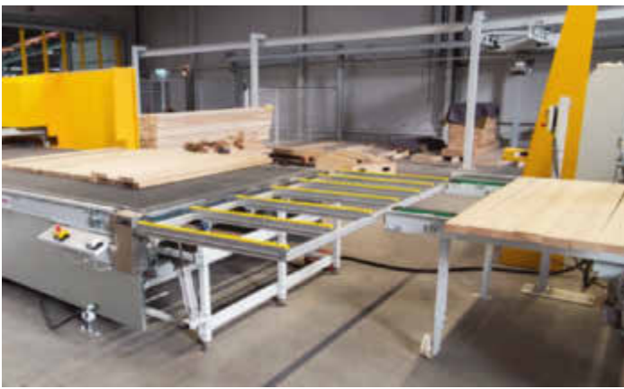
/ Sortier- und Qualitätsstation: Die einzelnen Lamellen werden durch einen Mitarbeiter zu einer Platte zusammengelegt und dann der Hochfrequenzpresse zugeführt.
