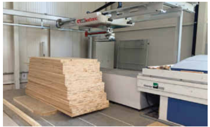
/ Abstapelmanipulator: Fertig gepresste Rohplatten werden mit dem Manipulator aufgenommen und abgestapelt.
