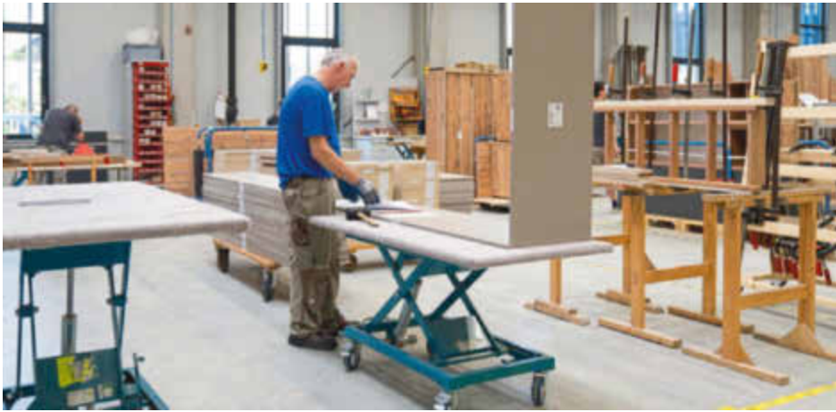
/ Ergonomie ist Trumpf: Im Bereich der Montage setzt Schuster auf Hubtische vom Typ HS 300 von Beck Maschinenbau. Diese sind stufenlos und unter Last höhenverstellbar und mit nur 70 kg Eigengewicht auch leicht verfahrbar.
