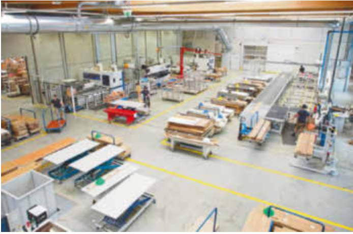
/ Hightech-Fertigung: Homag-CNCs, Ima-Kantenanleimmaschine und Hubtische des Typs HS 600 von Beck mit 600 kg Traglast und einem Nutzhub von 610 mm.
