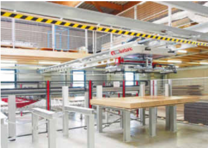
/ Auf hohen Durchsatz und Flexibilität getrimmt ist auch die automatische Säge-Lager-Kombination, bestehend aus Barbaric-Plattenlager CSF sowie einer ...
