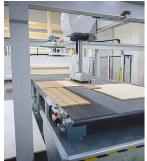
/ Der Entnahme-Manipulator kann Teile verschiedener Größen erfassen und auf Paletten etc. ablegen.
