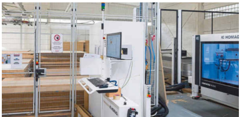
Im Vordergrund steht das Bedienterminal der CNC, links dahinter das Lager, hinten rechts die Etikettierstation und vorne rechts die CNC
