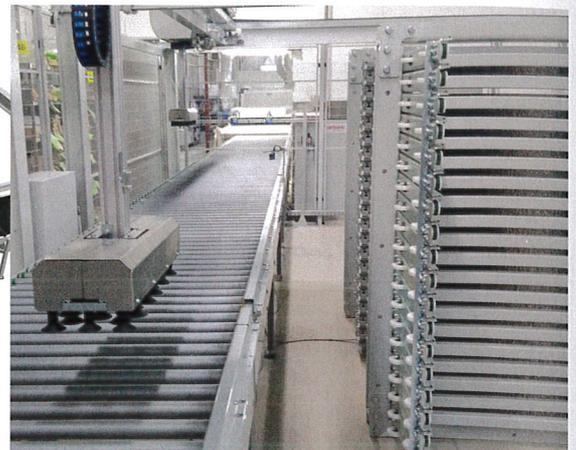
Rechts der Block mit Schubtablen, links der Beschicker
