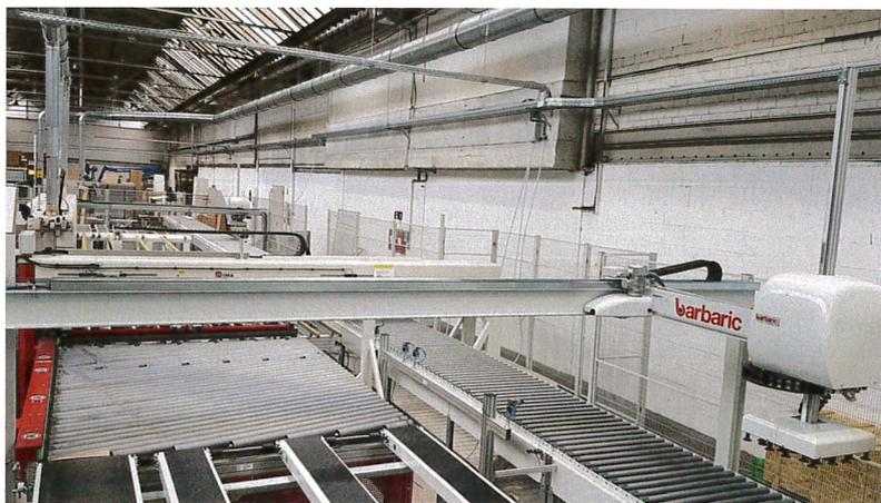
Dieses Gerät dreht, führt zurück und stapelt ab
