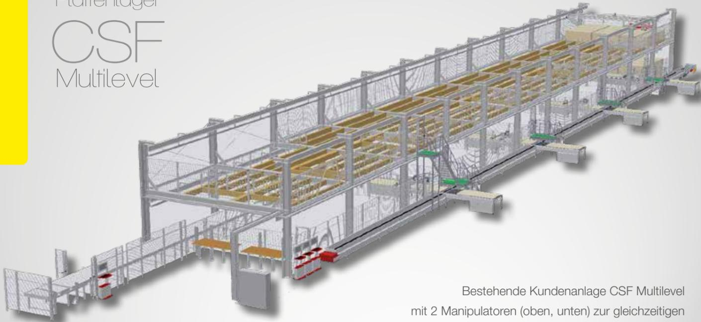
Bestehende Kundenanlage CSF Multilevel mit 2 Manipulatoren (oben, unten) zur gleichzeitigen Beschickung von 4 CNC-Maschinen
