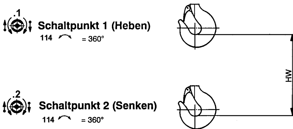
Illustration 22 : Limitation de la course du crochet
