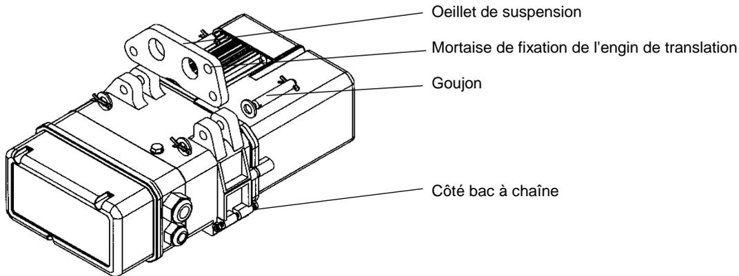
Illustration 6.: Suspension avec œillet de suspension
