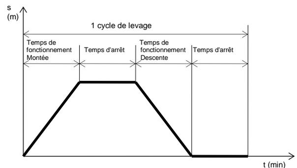
Le facteur de marche est limité par l'échauffement admissible du moteur de levage. Le temps de fonctionnement dépend de la hauteur de levage nécessaire, de la vitesse de levage du palan électrique à chaîne et du nombre de mouvements de levage pour un processus de transport précis (déchargement de camions, chargement de machines).
