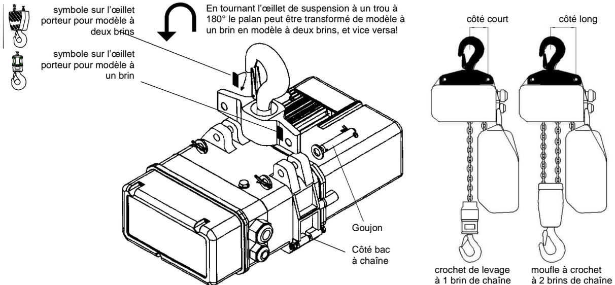
Illustration 8.: Suspension avec un crochet de suspension
