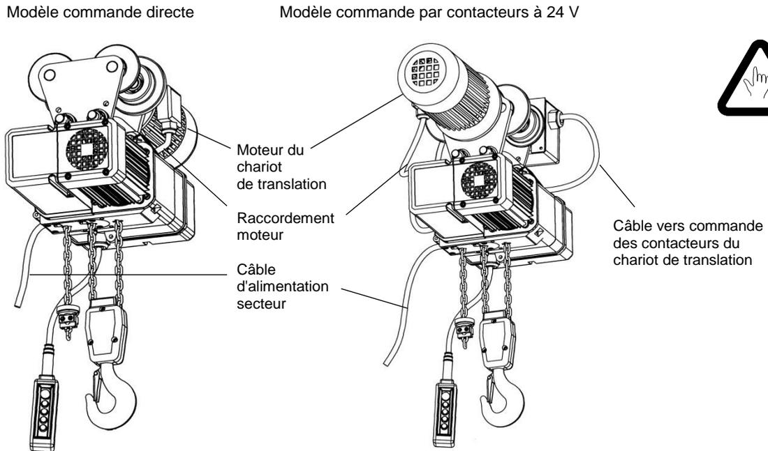
Illustration 22.: Disposition du chariot de translation par rapport au palan électrique à chaîne
