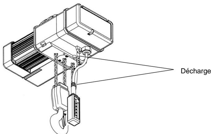
Illustration 32.: Fixation du dispositif d'arrêt de traction du
