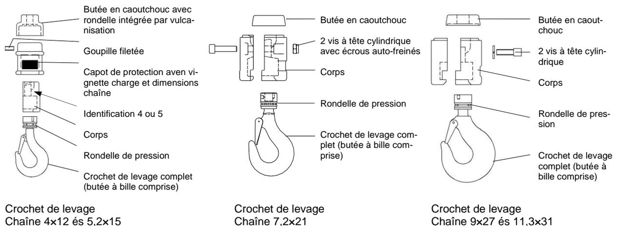
Illustration 4.: Structure du crochet de levage
